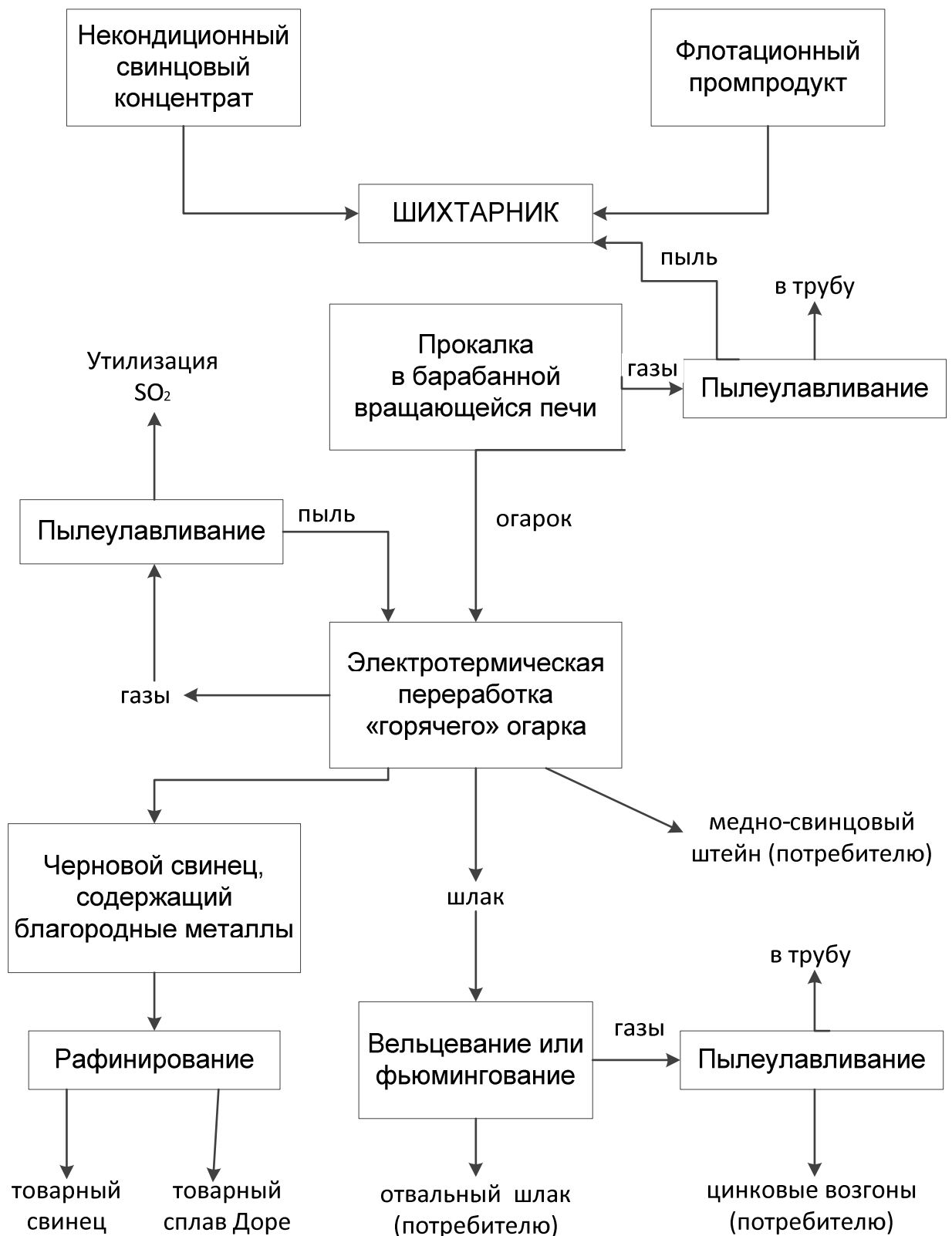
Рисунок 7.41 — Технологическая схема безотходной переработки некондиционных концентратов, содержащих благородные металлы
